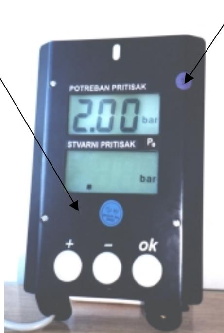
Slika 1: Fotografija mjernog dijela tlakomjera za gume tip MUR<sub>xx</sub>-PS<sub>x</sub> s prikazom mesta za smještaj ovjerne naljepnice I zaštitnog žiga
